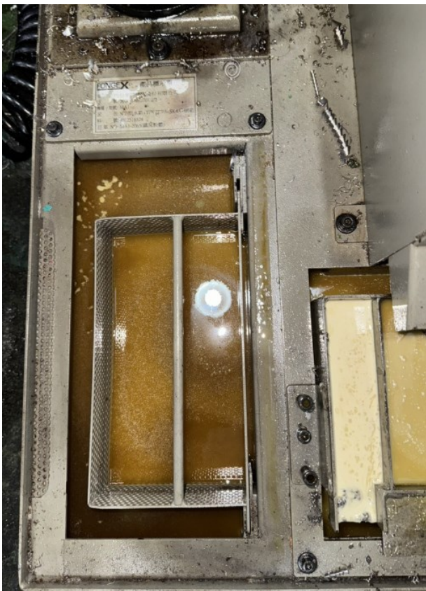
Bildet viser kjølevæsken før Best1 er benyttet
